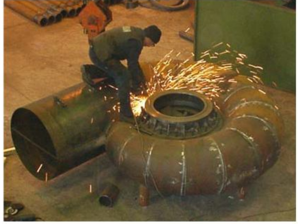
Şekil 3.49. Uskur çarkın tüm olarak unigraphics'te (vb.programla) çizilmesi, paslanmaz çelik malzemeden imal edilmiş 630 mm çapında çarkın ( 2 \text{ m}^3/\text{s} debi, 12.5 mSS düşü, % 80 verimle 200 kW) ve sacdan (10mm st42) kaynak yöntemi ile yapılan salyangozun tasarım genel görünüşü.
