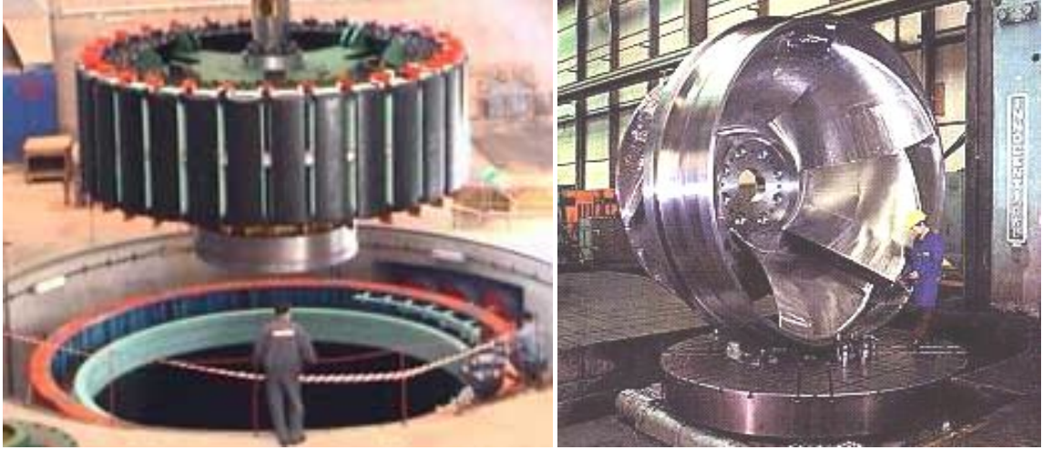
Şekil 3.43. Büyük Kapasiteli Francis Türbini, Türbin Çarkı (3.23m, 128MW) Ve Jeneratör Montajı
