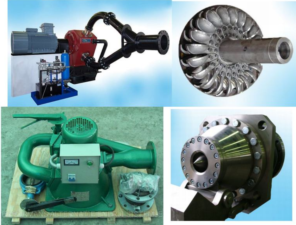
Şekil 3.29. İki adet İki lüleli modüler mini Pelton türbini, kepçeli çarkı ve lülesinin görüntüsü
