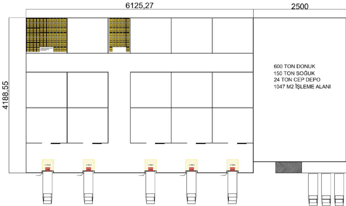
Şekil-15 Soğuk Hava Deposu Yerleşim Planı
