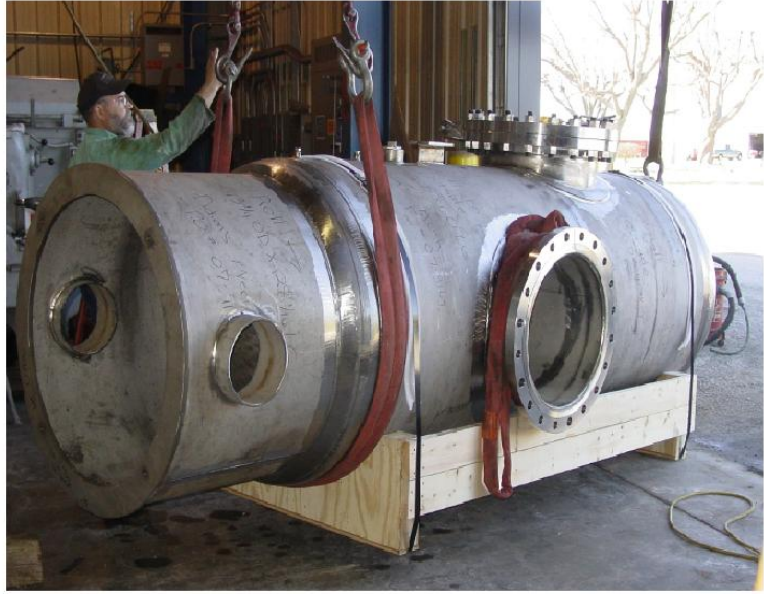
Şekil 32. DIDION SEPARATOR COMPANY Firmasına Ait Jeotermal Sistemlerde Kullanılan Separatör Çalışmaları (Anonim, 2012a)
