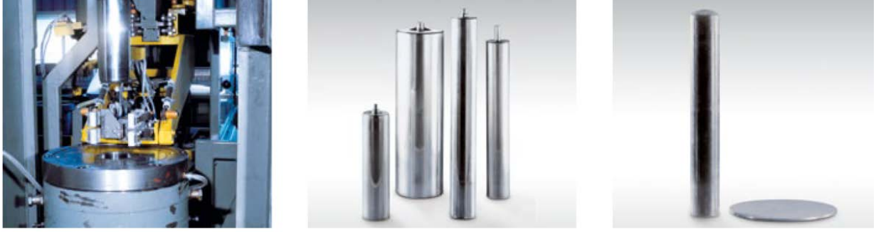
Şekillendirilmek üzere kalıba yönlendirilen kütük malzeme ve soğuk dövme ile şekillendirilmiş ürünler
