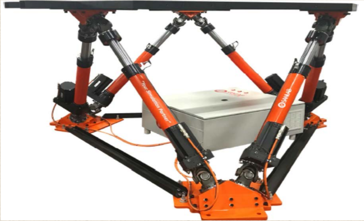
Resim: 6DOF Hareketli Plaftorm ve Aktüatör, SANLAB, Konya
